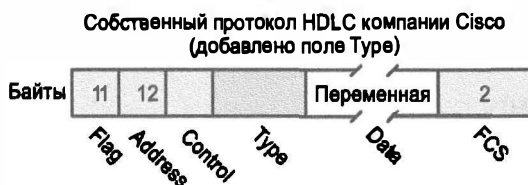
Рис. 3.6. Структура фрейма протокола HDLC
