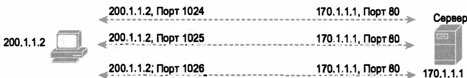
Рис. 24.7. Три соединения протокола TCP от одного компьютера
