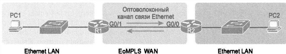
Рис. 3.10. Служба EoMPLS действует как простой канал связи Ethernet между двумя маршрутизаторами
