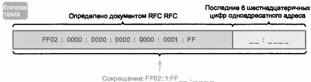
Рис. 27.9. Формат многоадресатного адреса опрашиваемого узла
