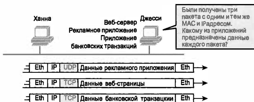
Рис. 5.2. Компьютер Ханны отправляет пакеты компьютеру Джесси с использованием трех приложений
