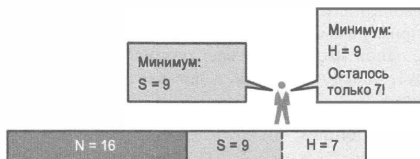
Рис. 19.3. Слишком мало битов для части хоста при данных требованиях
