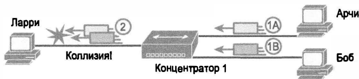
Рис. 2.18. Коллизия, вызванная поведением концентратора LAN
