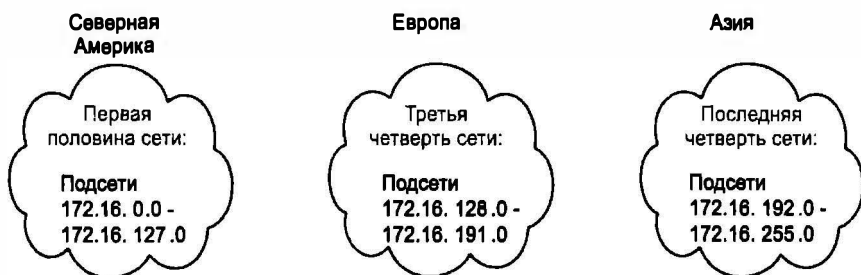
Рис. 11.20. Резервирование 50% подсетей для США и по 25% для Европы и Азии
