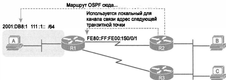
Рис. 29.9. Использование адресов, локальных в пределах канала связи
