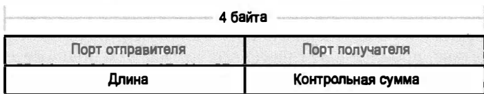
Рис. 5.7. Поля заголовка протокола UDP
