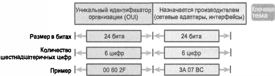
Рис. 2.15. Формат MAC-адресов Ethernet
