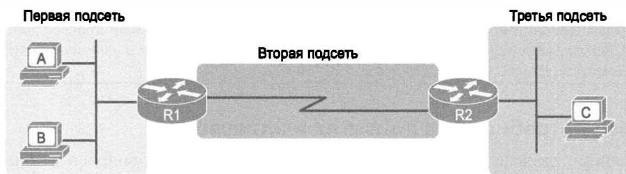
Рис. 11.3. Компьютеры А и В — в одной подсети, компьютер С — в другой
