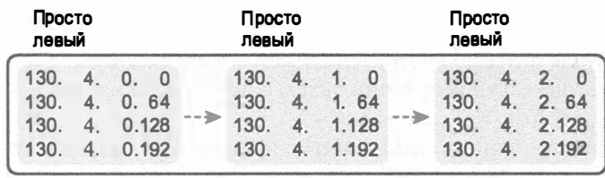
Рис. 19.14. Этап 2: репликация блока подсетей с добавлением единицы в просто левом октете
