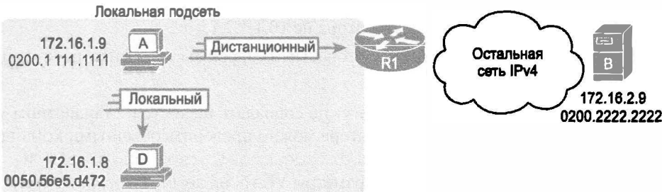
Рис. 18.8. IP- и MAC-адрес хоста в следующих двух примерах ARP
