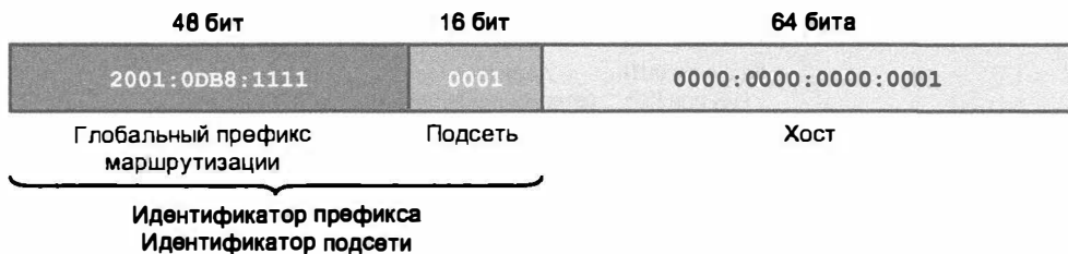
Рис. 26.10. Пример структуры адреса для компании CompuNet
