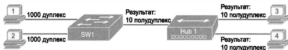
Рис. 6.15. Автопереговоры IEEE при концентраторе LAN
