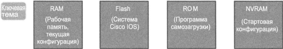
Рис. 7.9. Различные типы памяти коммутатора Cisco
