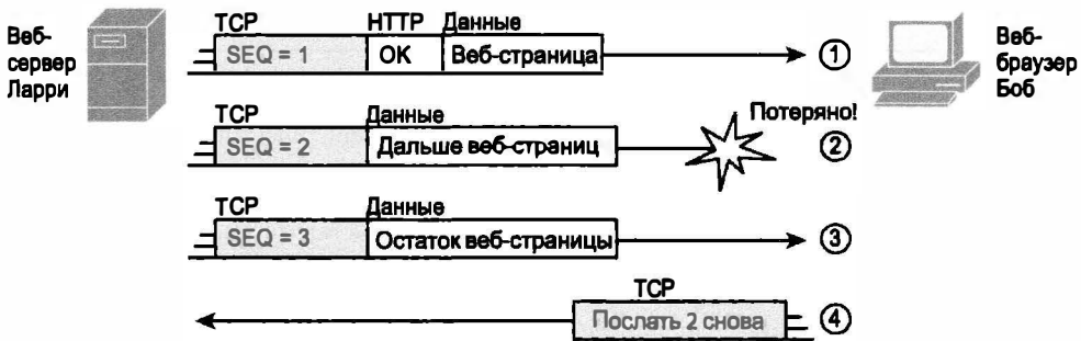
Рис. 1.7. Служба восстановления при ошибках протокола TCP, предоставляемая протоколу HTTP
