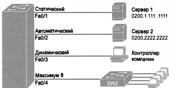
Рис. 8.8. Пример настройки защиты порта
