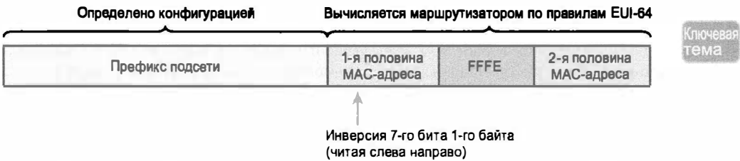
Рис. 27.4. Формат IPv6-адреса с идентификатором интерфейса и частью EUI-64
