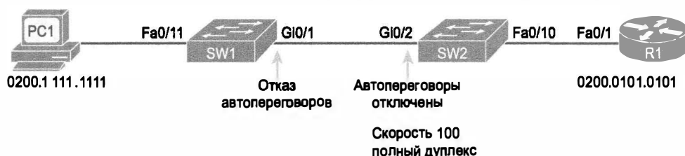
Рис. 10.4. Условия для рассогласования дуплекса между коммутаторами SW1 и SW2
