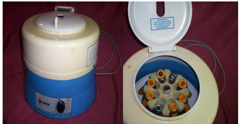
Figura 6: Centrífuga Fanem Macro com 8 tubos
