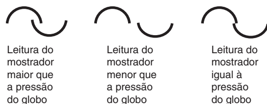
Fig. 2.9 Aparência dos semicírculos de fluoresceína, ou “mira”, através da ocular da lâmpada de fenda, mostrando o ponto final para tonometria de aplanação.
