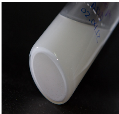
Figura 4 - Aspecto da deposição do pó no fundo após repouso
