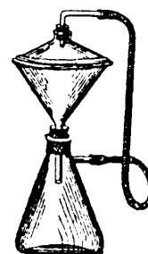
Fig. 298. Dispositivo para filtração de líquidos voláteis
