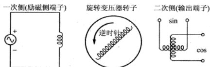
图 2.8 旋转变压器的构成
